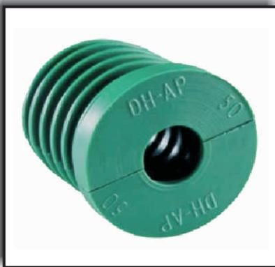
La serie **PLUG** è una guarnizione formata da due "conchiglie". È particolarmente apprezzata per la facilità e velocità di installazione, che può essere eseguita senza utensili speciali, basta un martello! Il disegno di speciale profilo assicura la tenuta fino a 3 bar e può essere installato
