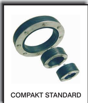
Il sistema di guarnizioni **COMPAKT** è il complemento perfetto all'**LS**. Basandosi sullo stesso principio, offre la guarnizione ideale per tubi e cavi. Il sistema **COMPAKT** è a tenuta stagna fino a 2 bar. È composto da 2 piastre in Acciaio inossidabile e un elemento di gomma spesso 40 mm. Il funzionamento è sempre lo stesso, avvitando i bulloni sulle piastre si verifica l'espansione radiale della gomma e quindi la tenuta. Sono disponibili versioni speciali, come quello a piastra aperta
